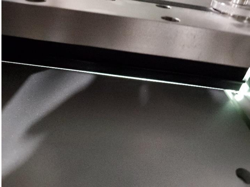
Fig. 3-5 Recoater blade install
